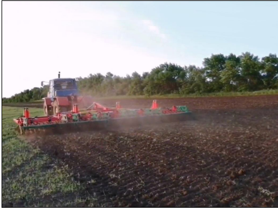
Рисунок 2 – Культиватор универсальный для сплошной обработки марки "Диас" БПК-8-230-Б-ШКСП в агрегате с трактором Т-150К на сплошной культивации
