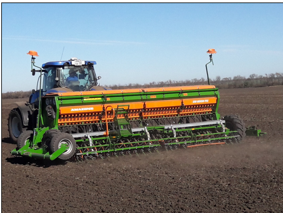
Рисунок 2 – Сеялка D9 6000-ТС, в агрегате трактором New Holland T7060 на посеве озимой пшеницы
