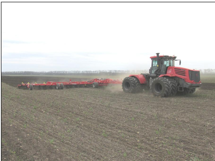
Рисунок 2 – Средний предпосевной культиватор "Tillermaster-20000" в агрегате с трактором К-744 Р4, на предпосевной сплошной культивации
