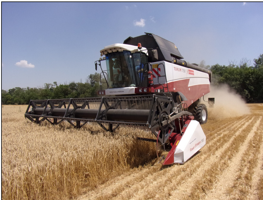
Рисунок 2 – Комбайн зерноуборочный РСМ-181 "TORUM-750", на прямом комбайнировании озимой пшеницы
