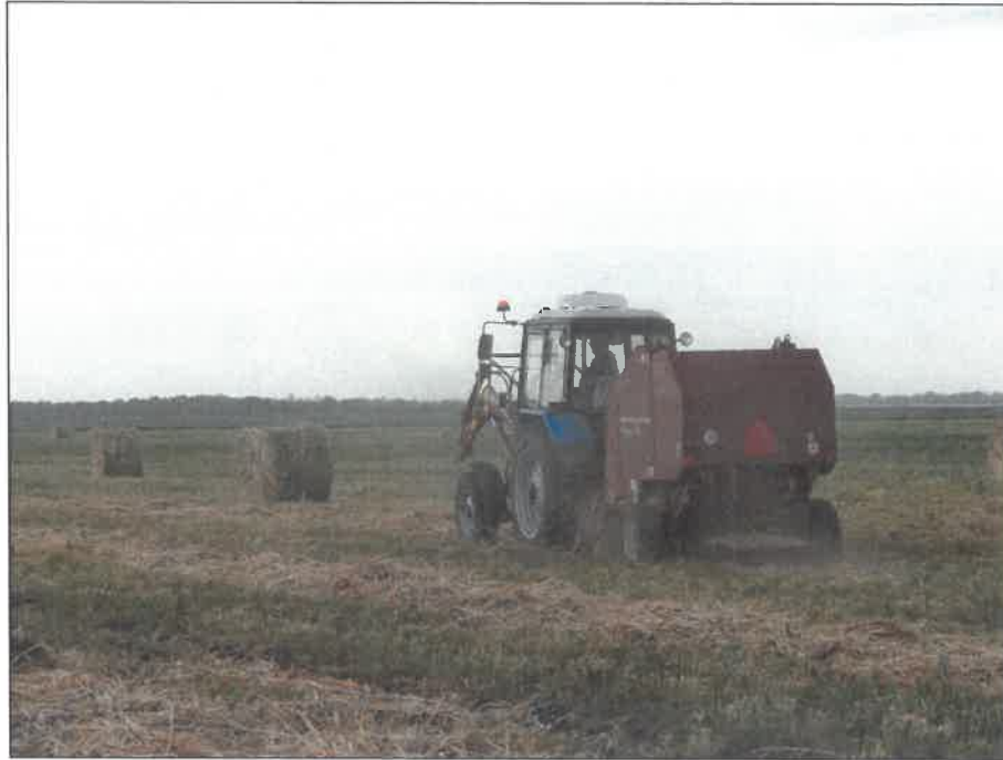
Рисунок 2 – Пресс-подборщик рулонный ППР-150 "Pelikan Max" в агрегате с трактором МТЗ-82 на подборе и прессовании валков сена в рулоны с обмоткой их шпагатом
