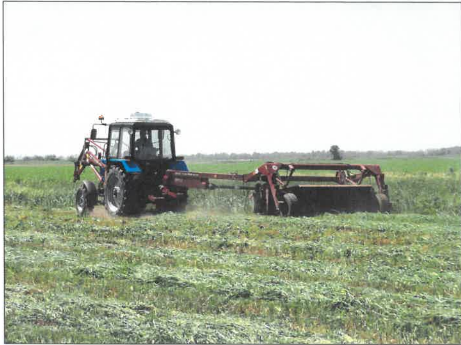
Рисунок 2 – Косилка роторная полуприцепная КРП-302-01 "Berkut UNO" в агрегате с трактором МТЗ-82 на скашивании трав и укладки их в валок
