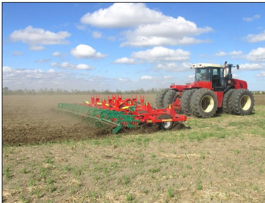
Рисунок 2 – Культиватор универсальный для сплошной обработки марки "Диас" БПК-12-230-Б-ШКСП в агрегате с трактором Versatile 2375, на сплошной культивации
