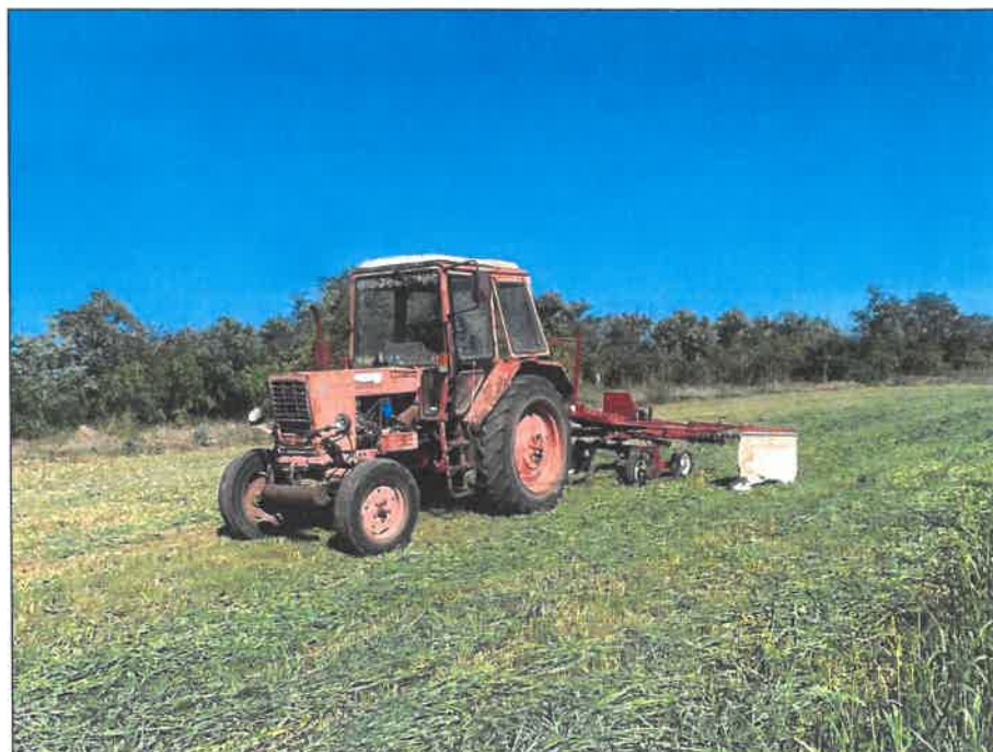
Рисунок 2 – Грабли роторные навесные ГРН-471 "Kolibri" в агрегате с трактором МТЗ-80 на сгребании травы из прокосов в валки
