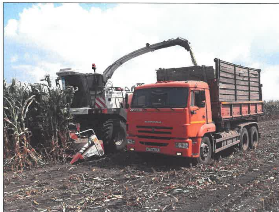
Рисунок 3 – Комбайн кормоуборочный РСМ-1401, на скашивании кукурузы на силос
