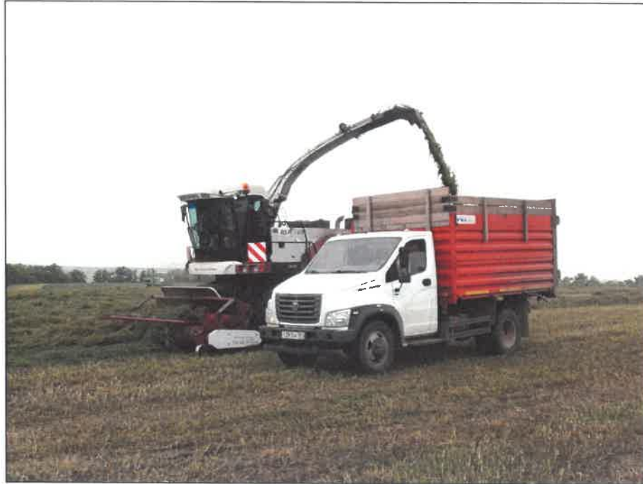
Рисунок 2 – Комбайн кормоуборочный РСМ-1401, на подборе валков подвяленной люцерны
