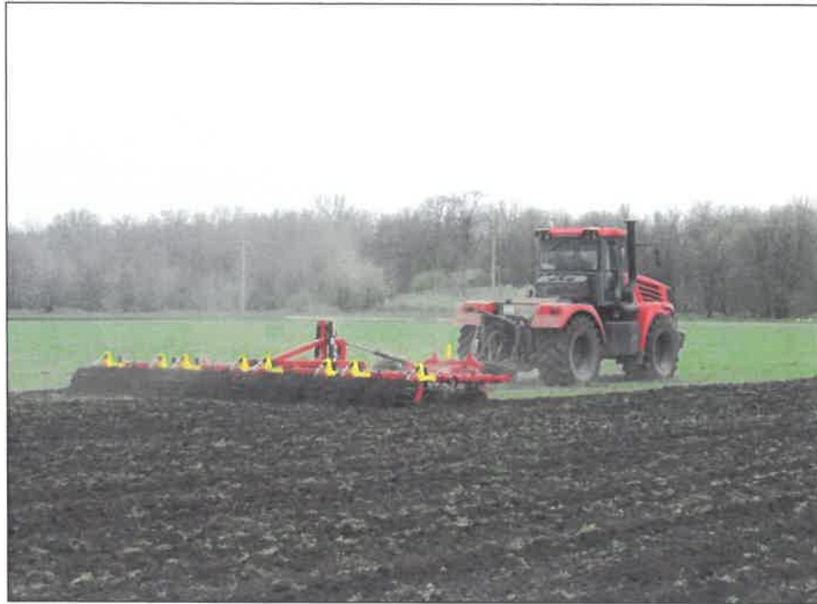
Рисунок 2 – Средний предпосевной культиватор "Tillermaster-8300" в агрегате с трактором К-744 РЗ, на предпосевной сплошной культивации
