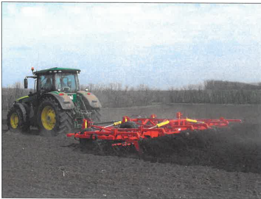
Рисунок 2 – Культиватор КС-8М в агрегате с трактором John Deere 8335R, на предпосевной культивации
