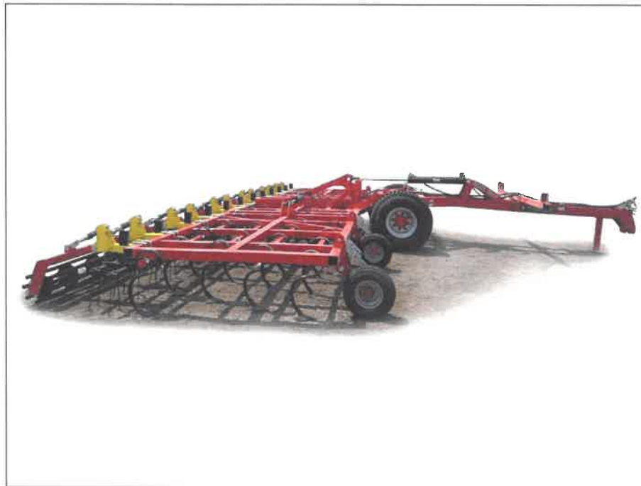
Рисунок 1 – Средний предпосевной культиватор "Tillermaster-12000", в рабочем положении
