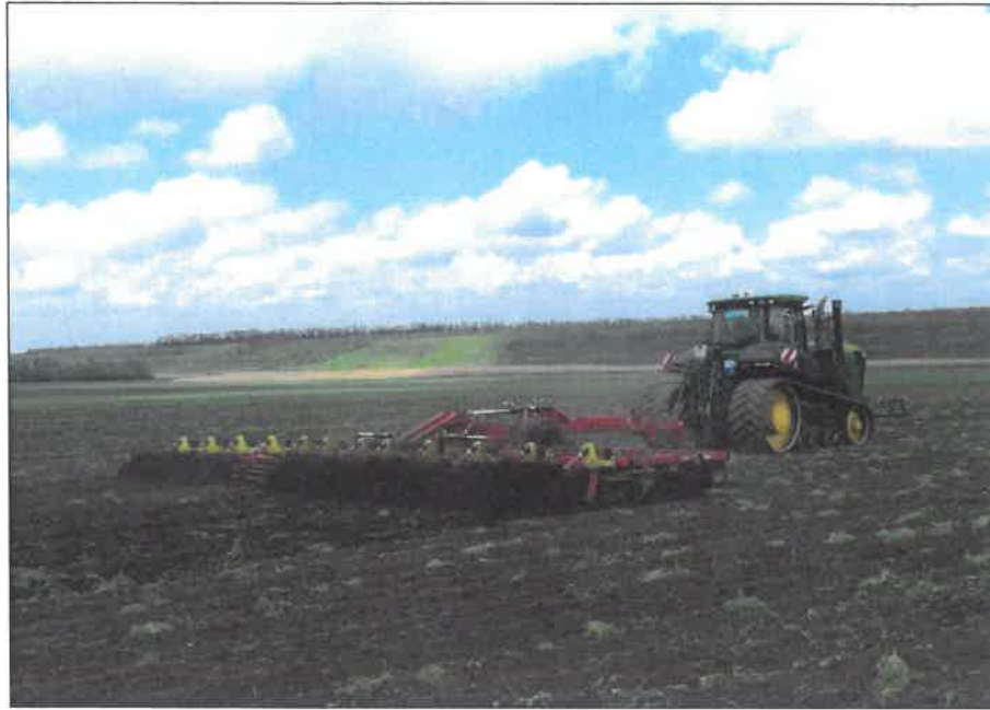
Рисунок 2 – Средний предпосевной культиватор "Tillermaster-12000" в агрегате с трактором John Deere 9430RT, на предпосевной сплошной культивации
