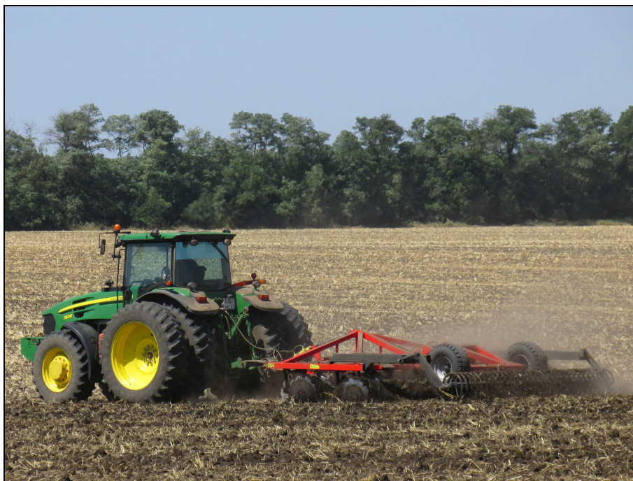
Рисунок 2 – Борона дисковая (Дискатор) БДМ 4×4ПР в агрегате с трактором Jonh Deere 7830 на дисковом лущении стерни озимой пшеницы (2 след)
