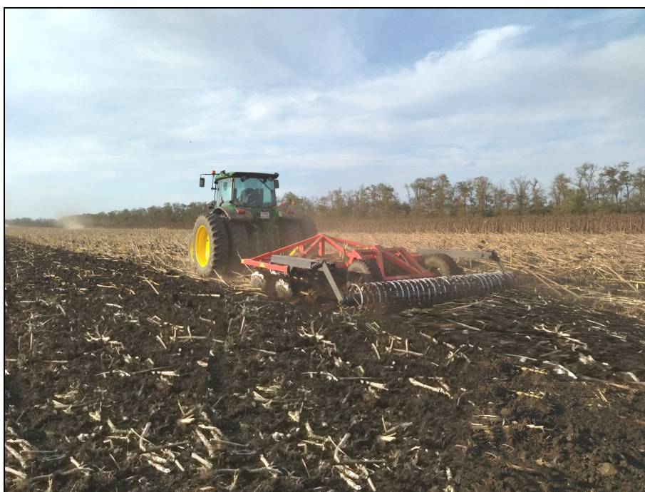
Рисунок 3 – Борона дисковая (Дискатор) БДМ 4×4ПР в агрегате с трактором Jonh Deere 7830 на дисковом лущении пожнивных остатков подсолнечника (1 след)
