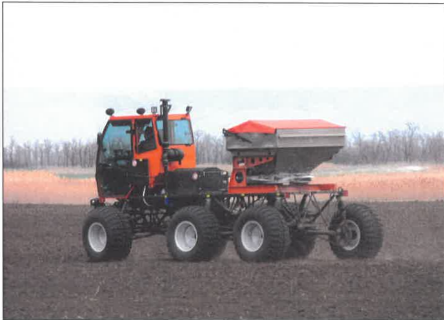
Рисунок 3 – Опрыскиватель-разбрасыватель самоходный Туман-1М комплектуемый сменным технологическим оборудованием (разбрасывателем уман-1М), на внесении аммиачной селитры под посев сахарной свеклы
