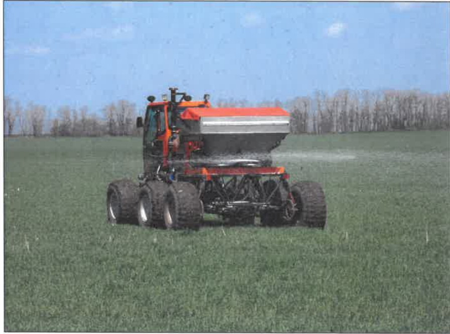
Рисунок 2 – Опрыскиватель-разбрасыватель самоходный Туман-1М комплектуемый сменным технологическим оборудованием (разбрасывателем уман-1М), на внесении аммиачной селитры по озимой пшенице
