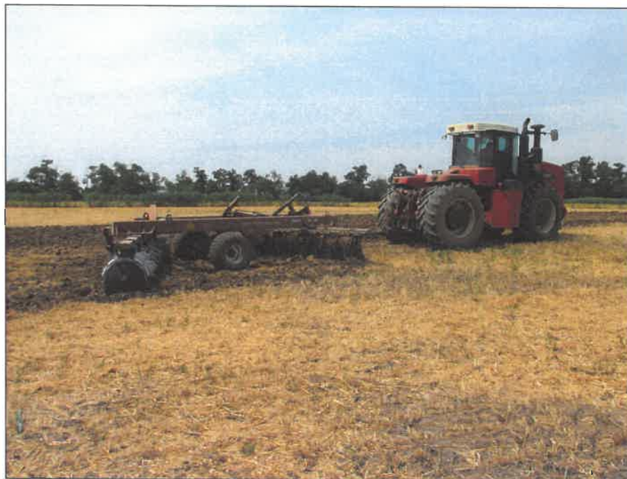
Рисунок 2 – Борона офсетная DV-1500/430 в агрегате с трактором Versatile-2375 на дисковом лущении стерни озимой пшеницы (1 след)
