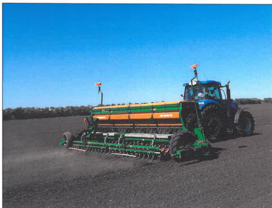
Рисунок 3 – Сеялка D9 6000-ТС в агрегате трактором New Holland T7060 на посеве люцерны
