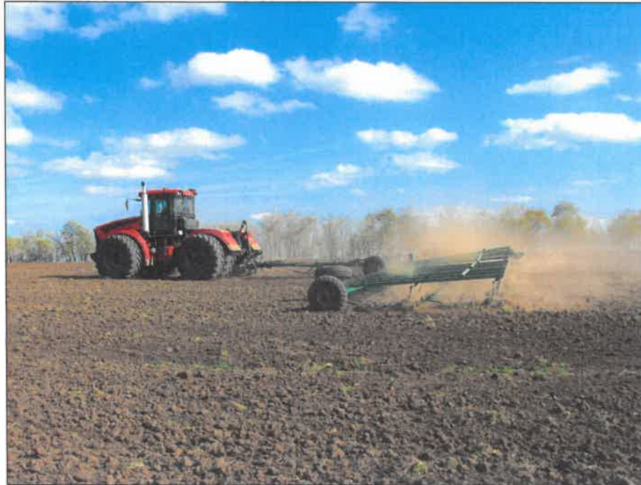
Рисунок 2 – Борона широкозахватная гидрофицированная БШГ -21-К1 "Пустельга" в агрегате с трактором К-742Пр на разрушении почвенной корки перед посевом озимых
