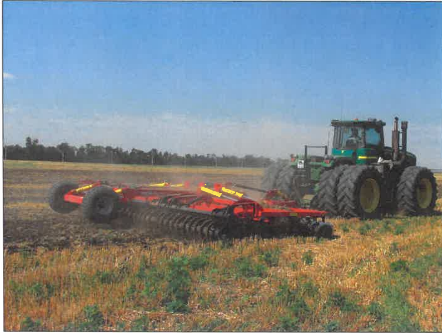
Рисунок 2 – Борона дисковая (Дискатор) БДМ 9×2ПТ в агрегате с трактором John Deere 9430 на дисковом лущении стерни озимого ячменя (1 след)
