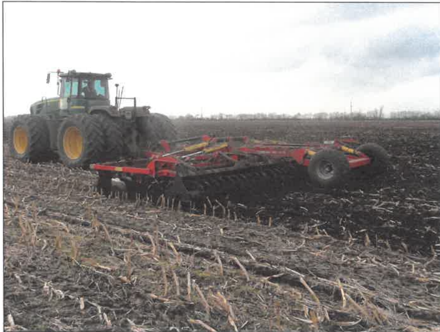
Рисунок 3 – Борона дисковая (Дискатор) БДМ 9×2ПТ в агрегате с трактором John Deere 9430 на дисковом лущении пожнивных остатков кукурузы (1 след)
