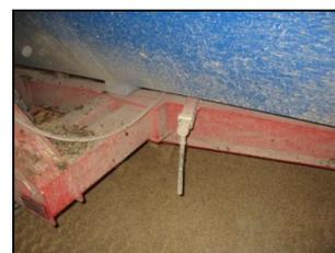
Полуприцеп тракторный самосвальный для жидких фракций ПТСЖ-6,5. Рукоятка стояночного тормоза
