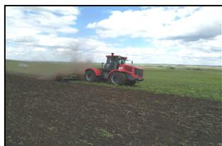
Борона дисковая CATROS-6002-2 в агрегате с трактором К-744Р3 на паровой обработке почвы
