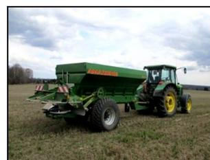
Разбрасыватель центробежный ZG-B 5500 Super в агрегате с трактором John Deere 6130D на поверхностном внесении гранулированных удобрений
