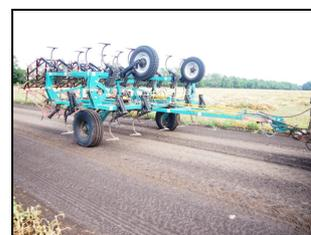
Культиватор паровой прицепной универсальный КППУ-8 с приспособлением КПП 140.00.000 и зубовыми боронами БЗСС-1,0 в транспортном положении
