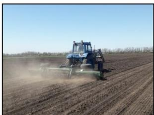
Каток кольчато-зубчатый ККЗ-6 в агрегате с трактором МТЗ-80 на прикатывании посевов подсолнечника
