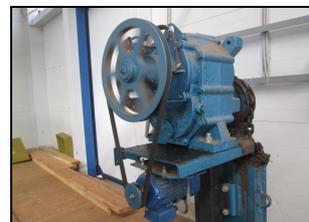
Ременная передача вертикальной приводной станции
