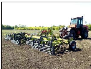
Культиватор модульный прицепной "Антарес" КМП-14 в агрегате с трактором К-744РЗ, на паровой обработке почвы
