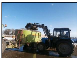
Смеситель-раздатчик кормов СРК-12В "Хозяин" в агрегате с трактором AGROLUX-4.8 на погрузке силоса
