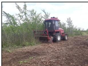
Мульчирующая фреза 550.00.000 в агрегате с энергосредством УЭС-2-280А на валке и измельчении стоящей древесной растительности
