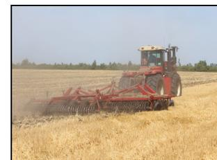
Борона дисковая модульная прицепная БДМП-8х4С-01 в агрегате с трактором Versatile 2375 на основной обработке почвы
