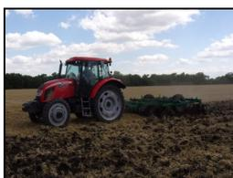
Трактор сельскохозяйственный колесный ANT 4135F в агрегате с бороной дисковой БДМ-4 на дисковом лущении стерни озимой пшеницы (фон 2)
