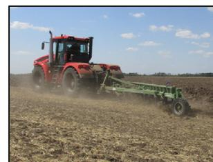
Трактор колесный "Кировец" К-735МСт1 в агрегате с плугом ПНУУ-8×40 на отвальной вспашке почвы (фон 1)
