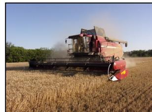
Комбайн зерноуборочный КЗС-3321КР с жаткой ЖЗС-9-1 на прямом комбайнировании озимой пшеницы
