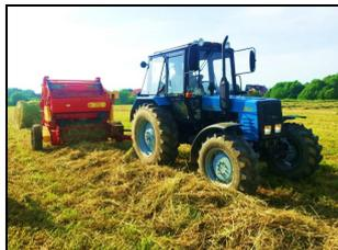
Пресс-подборщик рулонный ПР-145С в агрегате с трактором МТЗ-920 на подборе и прессовании сена
