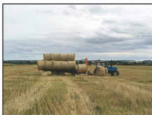
Подборщик-транспортировщик рулонов TRB 20 в агрегате с трактором Беларус 1221.3 на подборе цилиндрических рулонов соломы
