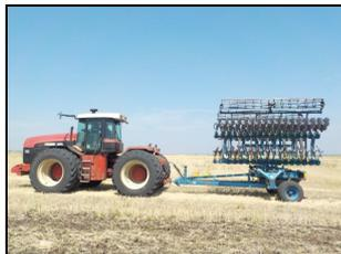
Агрегат дисковый АДС-8 в транспортном положении с трактором Versatile 2375
