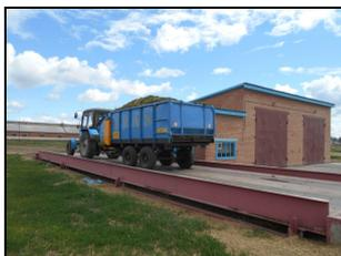
Кормораздатчик тракторный полуприцепной КТП-10У в агрегате с трактором МТЗ-82.1
