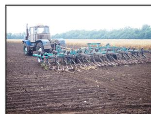
Культиватор паровой прицепной универсальный КППУ-8 с приспособлением КПП 140.00.000 и зубовыми боронами БЗСС-1,0 в агрегате с трактором Т-150К на культивации пара
