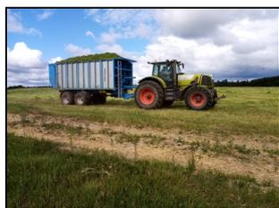
Полуприцеп с подпрессовкой и разбрасывателем органических удобрений ПСП-15 НР в агрегате с трактором CLAAS ATLES 946 на транспортировке измельченной зеленой массы
