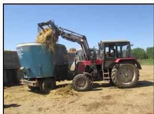
Агрегат АКМ-9 на загрузке компонентов кормосмеси
