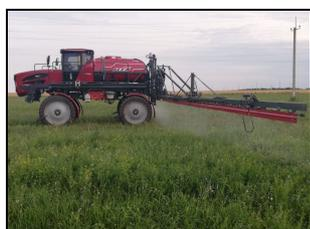
Самоходный опрыскиватель "УТА-3000" на подкормке многолетних трав минеральным микроудобрением путем поверхностного микрораспыления
