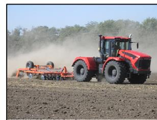
Трактор колесный "Кировец" К-735МСт1 в агрегате с боронной дисковой БДМ-5×4 на дисковом лушении почвы после уборки сахарной свеклы (1 след) (фон 2)
