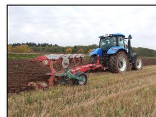
Плуг пятикорпусный оборотный Kverneland KKED 85-200 в агрегате с трактором New Holland T6090 на вспашке поля после уборки зерновых
