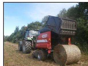
Пресс-подборщик EXTREME 265 НТІ в агрегате с трактором Agrotрон 165.на подборе валков сена и прессовании с последующей обмоткой сеткой
