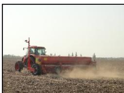
Трактор сельскохозяйственный колесный ANT 4135F в агрегате с зерновой сеялкой ЗС-6 на посеве озимой пшеницы (фон 4)
