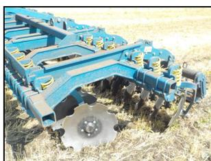
Рабочие органы агрегата дискового АДС-8
