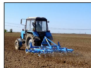
Культиватор КБМ-4,2НУ в агрегате с трактором Беларус 82.1, на предпосевной культивации почвы
