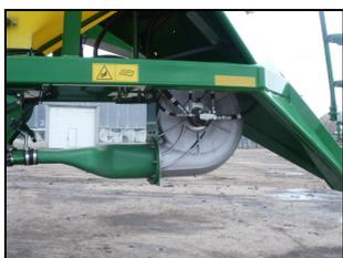
Вентилятор с гидроприводом
