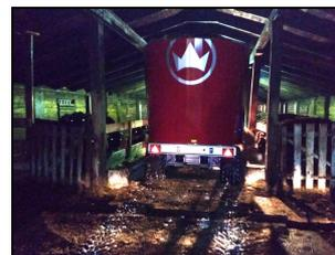
Кормосмеситель Siloking TrailedLine Classic Compact 9 в агрегате с трактором МТЗ-82.1 на раздаче кормовой смеси
