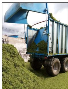
Полуприцеп с подпрессовкой ПСП-15 НР на разгрузке измельченной зеленой массы
