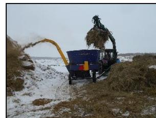
Измельчитель кормов роторный РИК-8 в агрегате с трактором МТЗ-80 на измельчении сена
