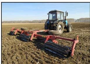
Каток-измельчитель водоналивной КИВ-9 в рабочем положении в агрегате с трактором МТЗ 1221.2 на измельчении пожнивных остатков подсолнечника
