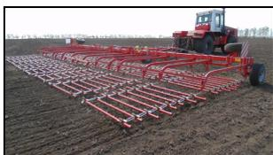
Борона шлейфовая LARI-15 в агрегате с трактором К-744 Р1 на предпосевной подготовке почвы
