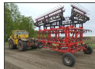
Культиватор сплошной КС-12(У) в агрегате с трактором К-701 в транспортном положении
