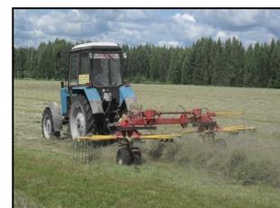
Грабли-ворошилка GVR-6B в агрегате с трактором МТЗ-82.1 на сгребании сена из прокоса в валок
