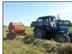
Пресс-подборщик рулонный ПР-140 в агрегате с трактором МТЗ-920 на подборе и прессовании сена
