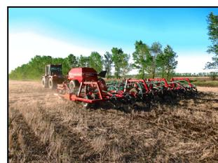
Комбинированный посевной комплекс КПК-990АП в агрегате с трактором VERSATILE 2375 на посеве яровой пшеницы без внесения удобрений
