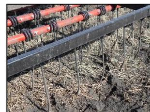
Рабочие органы борона тяжелой пружинной "СоломМастер" БП 21-58 (зуб пружинный круглый)
