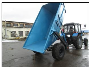
Полуприцеп самосвальный ПС-7 с кузовом в поднятом положении.
