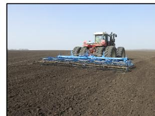
– Трактор сельскохозяйственный Versatile 2375 в агрегате с культиватором Kogund 8/900K на предпосевной культивации почвы под посев кукурузы (фон 2)
