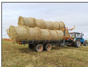
Подборщик-транспортировщик рулонов TRB 20 в агрегате с трактором Беларус 1221.3 на транспортировке цилиндрических рулонов соломы
