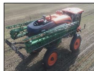
Самоходный опрыскиватель "IMPERADOR 4000" в транспортном положении
