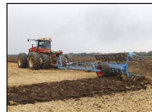
Плуг оборотный Diamant 16 (8+1) в работе в агрегате с трактором RSM 2375 на вспашке задискованной стерни озимой пшеницы
