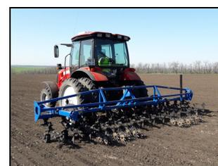
Культиватор-растениепитатель широкозахватный КРШ-8,1Г-01 в агрегате с трактором Беларус 1523.3 на междурядной культивации сахарной свеклы
