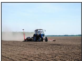
Сеялка универсальная пневматическая VESTA 8 PROFI (УПС-8А) в агрегате с трактором МТЗ-82.1 на посеvе семян кукурузы
