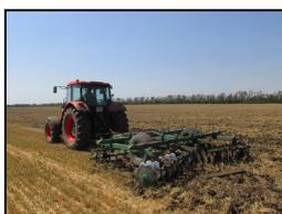
Трактор сельскохозяйственный колесный ANT 4135F в агрегате с бороной дисковой БДМ-4 на дисковом лущении стерни озимого ячменя (фон 1)
