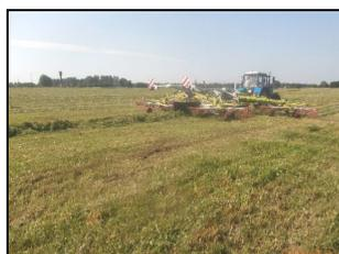
Валкователь LINER 3600 в агрегате с трактором Беларус 1221. на укладке в валки многолетних трав после скашивания
