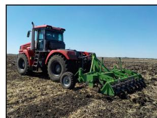
Глубокорыхлитель навесной ГРП-4 в агрегате с трактором К-739Ст на глубоком рыхлении почвы
