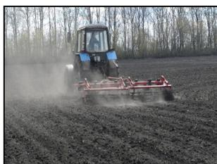
Культиватор широкозахватный универсальный ПОЛЯРИС-4 в агрегате с трактором Беларус-1221 на предпосевной культивации почвы
