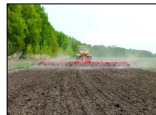
Культиватор сплошной КС-12(У) в агрегате с трактором К-701 на предпосевной культивации почвы
