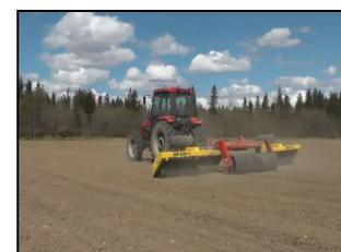
Каток полевой AW-630G в агрегате с трактором Mahindra 7590 4WD, на прикатывании почвы после посева зерновых
