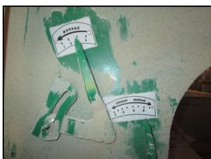
Рычаги с секторами регулировок дробилки
