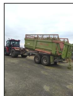
Полуприцеп ПСКТ-18 "Хозяин" в агрегате с трактором К-744.
