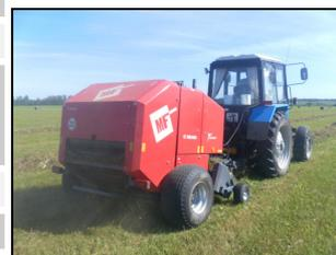
Рулонный пресс-подборщик Z562 в агрегате с трактором МТЗ-82.1
