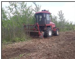
Энергосредство УЭС-2-280А в агрегате с мульчирующей фрезой 550.00.000 на валке и измельчении стоящей древесной растительности
