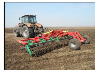
Борона дисковая модернизированная марки "ДИАС" БДМ-8х2 в агрегате с трактором TERRION АТМ7360 на поверхностной обработке почвы
