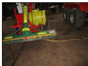
Протравливатель ПС-20М-4. Приемный шнек
