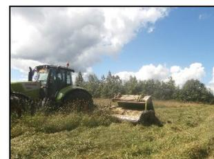
Косилка Disco 9200 C - 3200 FC Profil HD в агрегате с трактором AXION 850 на скашивании многолетних сеяных трав.
