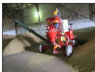
Протравливатель ПС-20М-4 на протравливание семян из бурта в бурт
