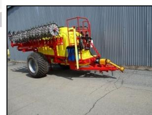
Агрегат почвенного внесения удобрения "У-КАС АПВУ-9" в транспортном положении
