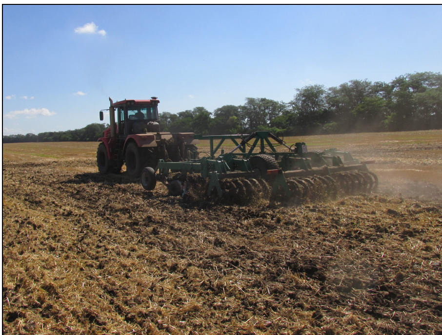
Рисунок 2 – Борона дисковая тяжелая БДУ-6,4 в агрегате с трактором К-744, на дисковой обработке стерни озимой пшеницы
