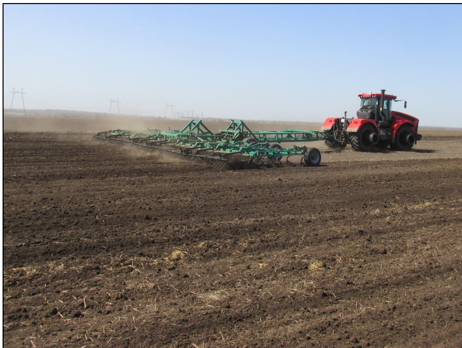
Рисунок 2 – Культиватор КПП-14,5 в агрегате с трактором К-742 МПр
