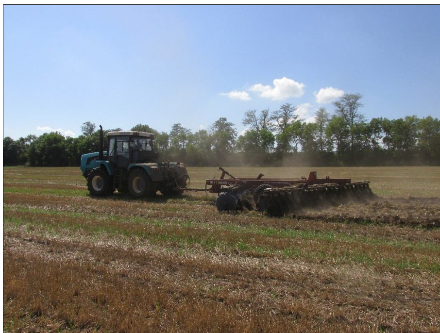
Рисунок 2 – Трактор БТЗ-243К сельскохозяйственный колесный общего назначения, с четырьмя ведущими колесами, тягового класса 3 в агрегате с бороной DV-1000/600, в работе
