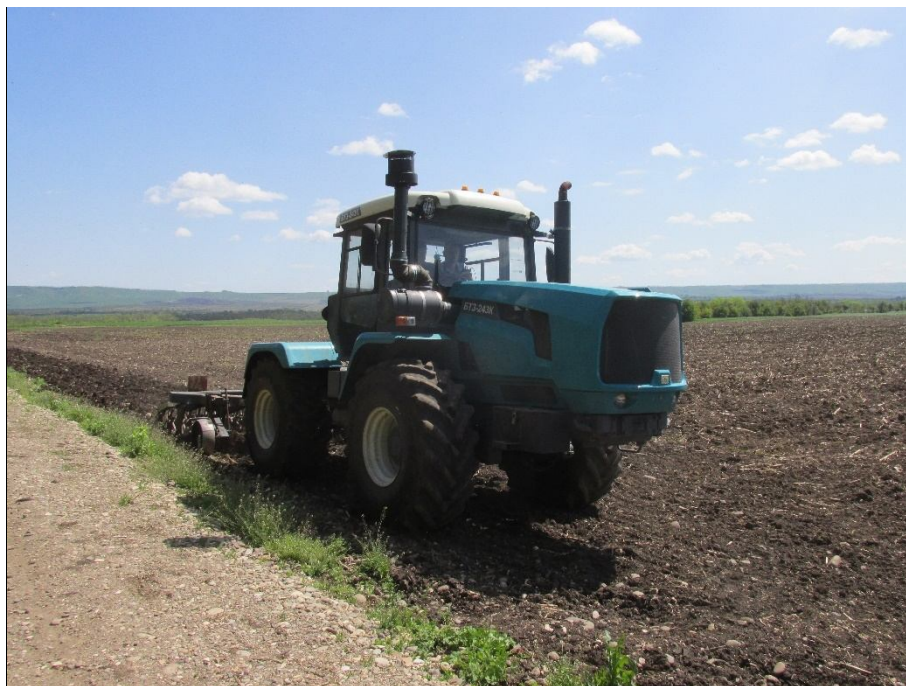
Рисунок 1 – Трактор БТЗ-243К сельскохозяйственный колесный общего назначения, с четырьмя ведущими колесами, тягового класса 3
