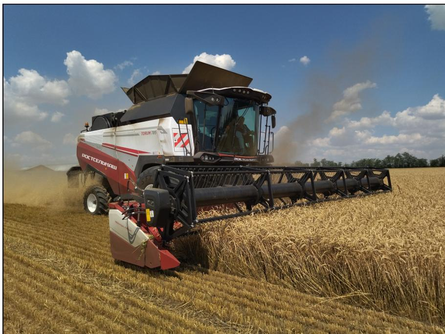
Рисунок 2 – Комбайн зерноуборочный самоходный РСМ-181 "TORUM-785", на уборке озимой пшеницы
