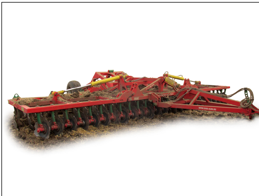
Рисунок 1 – Борона дисковая модернизированная марки "ДИАС", модель БДМ-8×3ПК-ШКС
