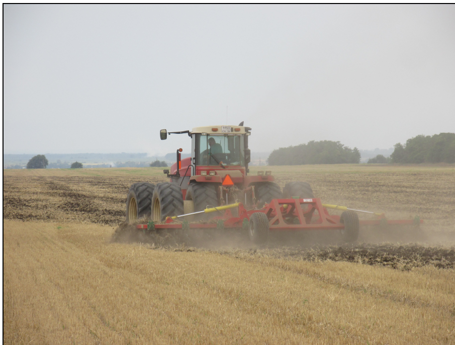
Рисунок 2 – Борона дисковая модернизированная марки "ДИАС", модель БДМ-8×3ПК-ШКС в агрегате с трактором Versatile 2375 на дисковом лушении стерни озимой пшеницы (1 след)
