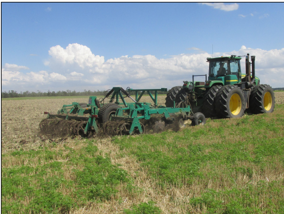
Рисунок 2 – Борона дисковая тяжелая БДУ-6,4 в агрегате с трактором John Deere 9430 на дисковом лушении стерни озимой пшеницы (1 след)
