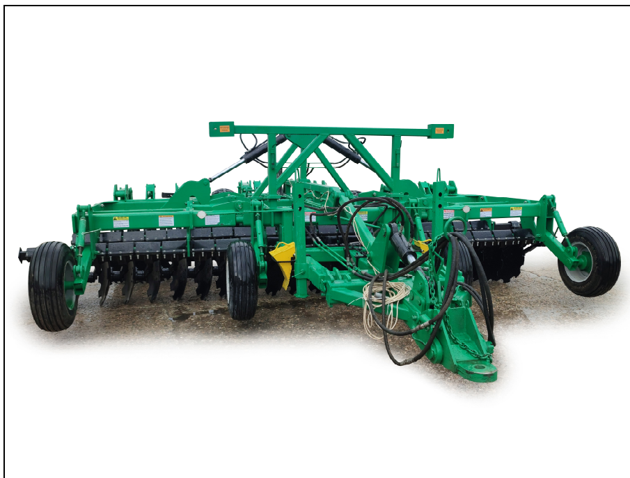
Рисунок 1 – Борона дисковая тяжелая БДУ-6,4 вид спереди справа
