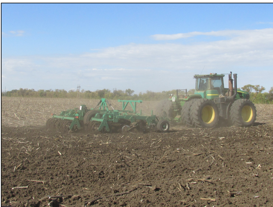
Рисунок 3 – Борона дисковая тяжелая БДУ-6,4 в агрегате с трактором John Deere 9430 на дисковом лушении пожнивных остатков подсолнечника (1 след)
