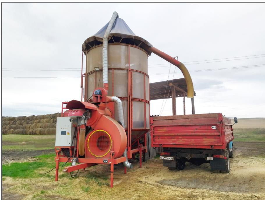
Рисунок 2 – Зерносушилка передвижная, торговая марка "АТМ", модель АТМ-20, в работе (на сушке зерна)
