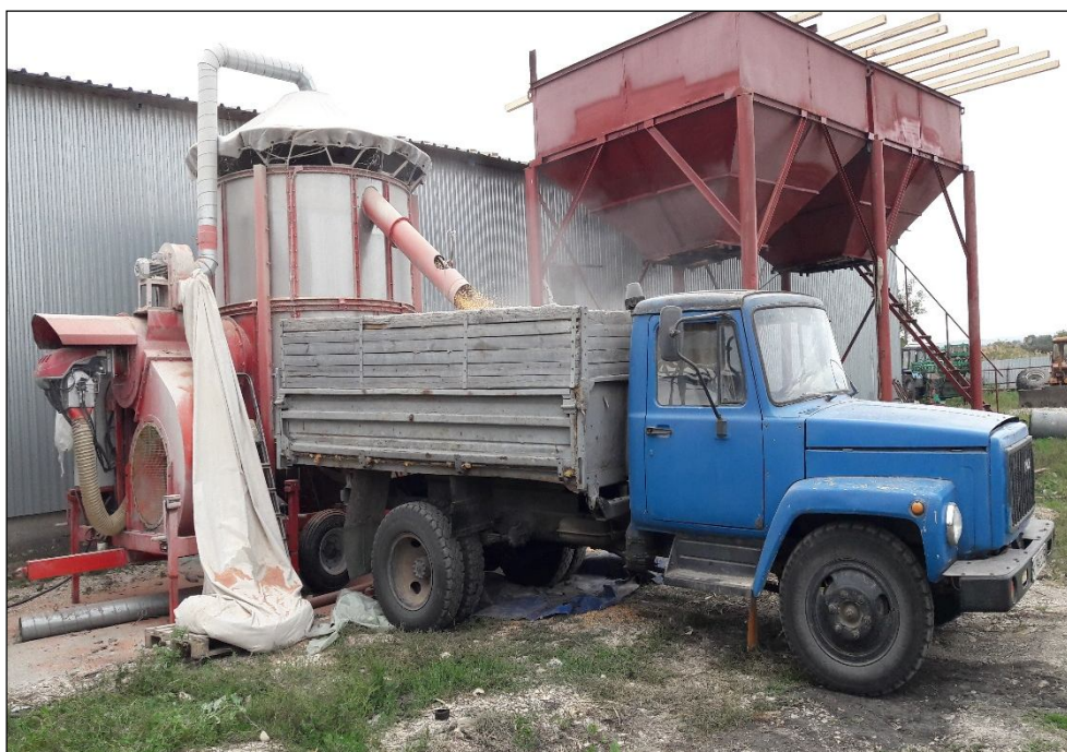
Рисунок 2 – Зерносушилка передвижная, торговая марка "АТМ", модель АТМ-10, в работе (на сушке зерна кукурузы)
