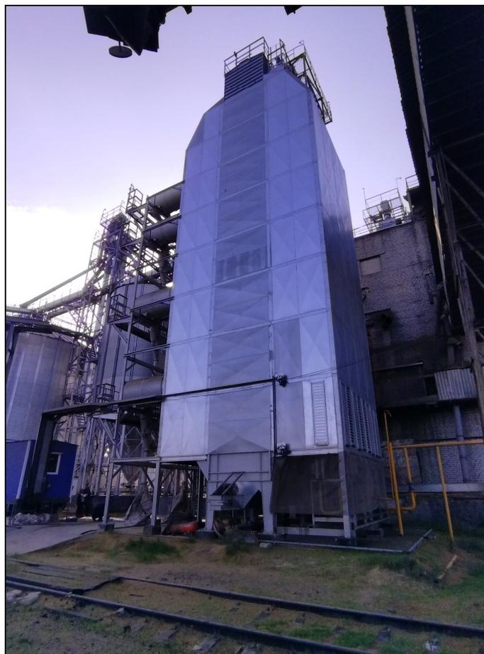
Рисунок 1 – Зерносушилка модульная жалюзийная модель FLATUM 8-16, вид спереди справа
