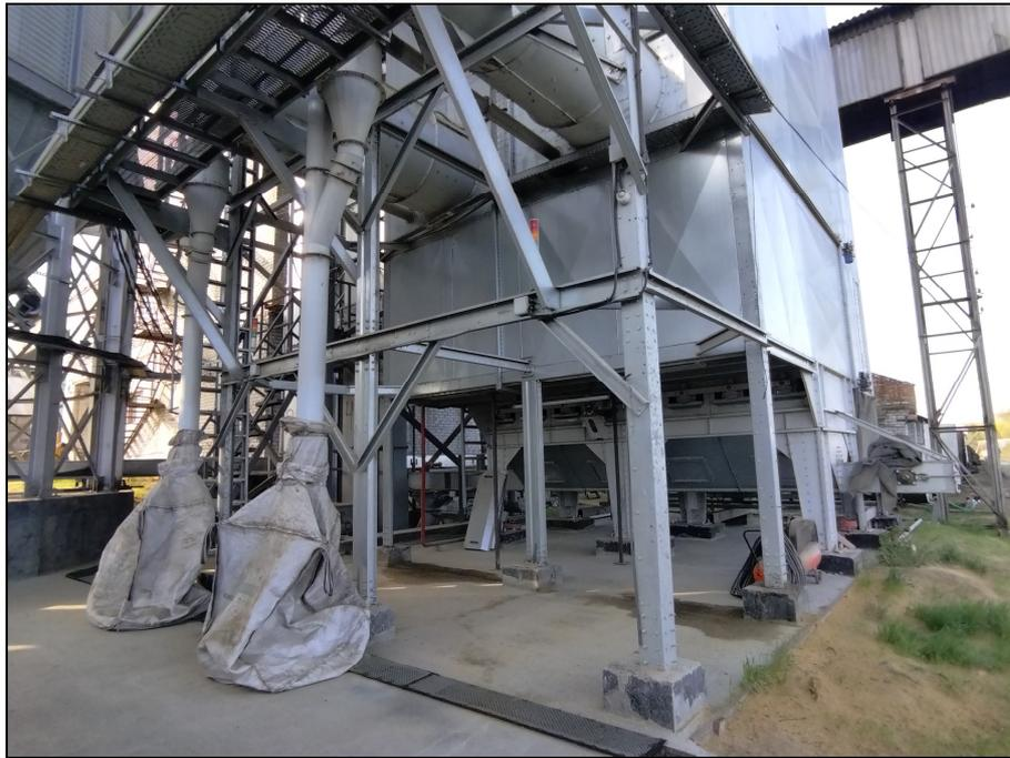
Рисунок 2 – Зерносушилка модульная жалюзийная модель FLATUM 8-16, в работе (на сушке зерна)
