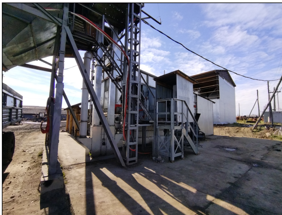
Рисунок 2 – Зерносушилка конвейерного типа Motum-15, в работе (на сушке зерна пшеницы)
