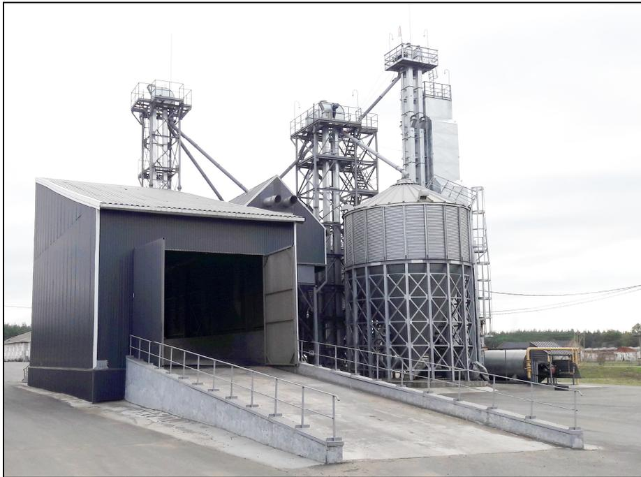
Рисунок 2 – Сушилка зерновая шахтная модульная типа "С" С-40 "Стандарт" с косвенным типом нагрева, вид топлива газ, в работе (на сушке зерна)
