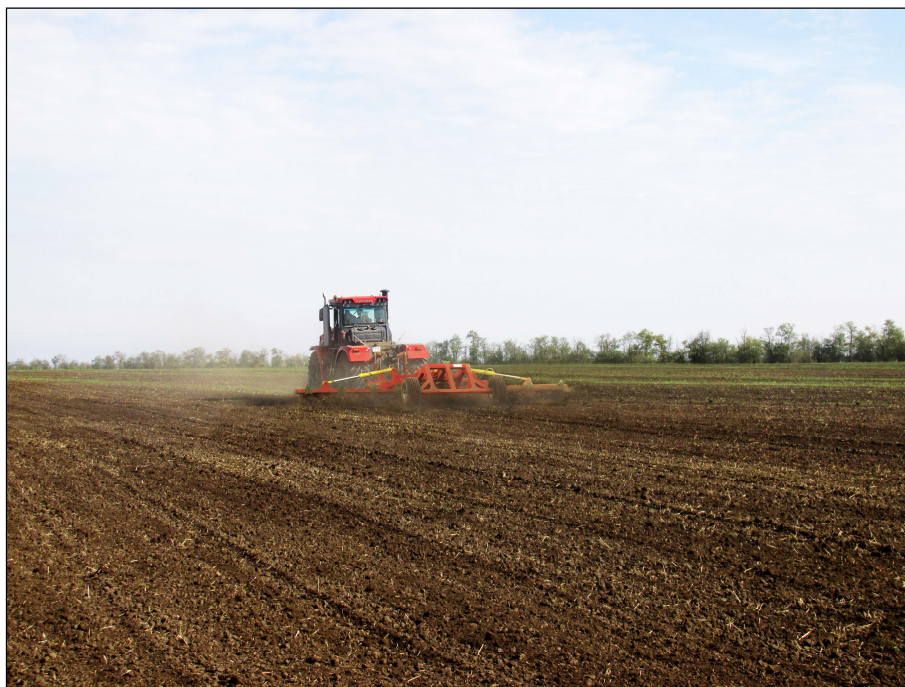
Рисунок 2 – Борона дисковая модернизированная марки "Диас", модель БДМ-9×2ПК-Д-ШКС в агрегате с трактором К 744РЗ на дисковом лушении стерни озимой пшеницы (2 след)
