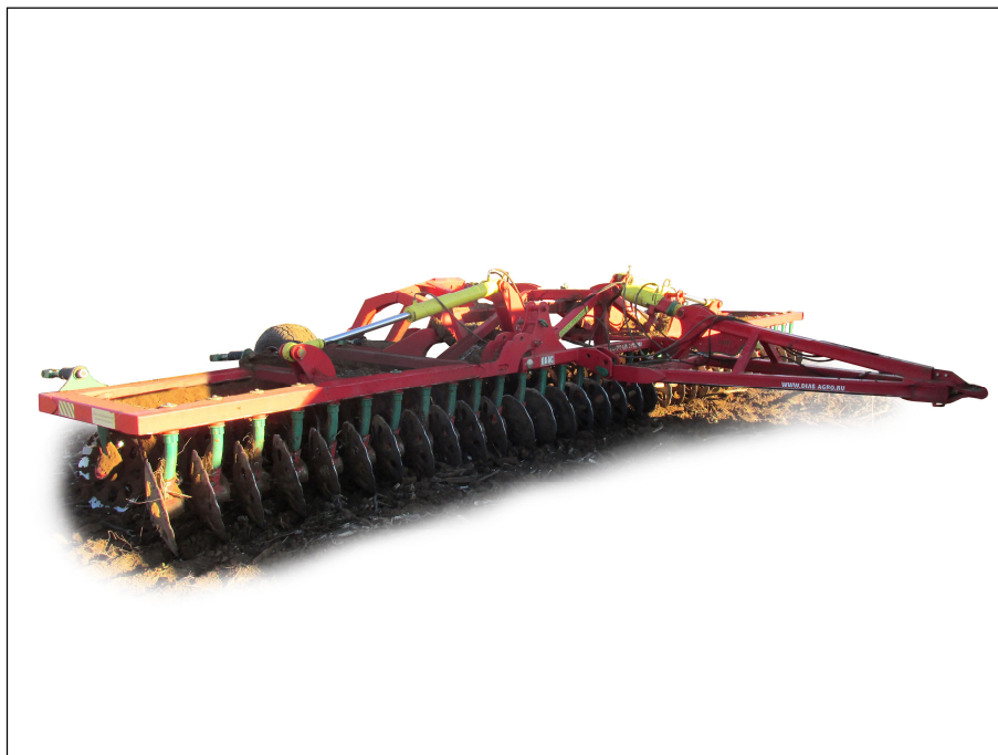
Рисунок 1 – Борона дисковая модернизированная марки "Диас", модель БДМ-9×2ПК-Д-ШКС, вид спереди справа
