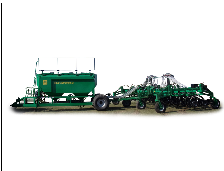
Рисунок 1 – Посевной комплекс ПК-10,0М "Ставрополье", вид спереди слева
