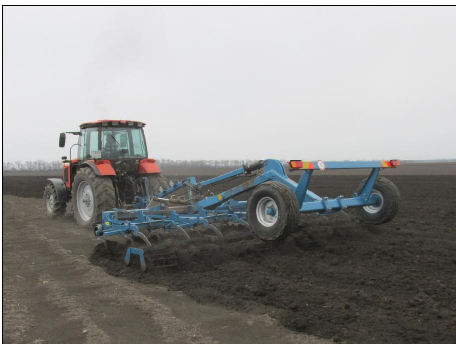
Рисунок 3 – Культиватор предпосевной торговой марки "TIGARBO" модель КПП-6 в агрегате с трактором Беларус-2022, на предпосевной культивации
