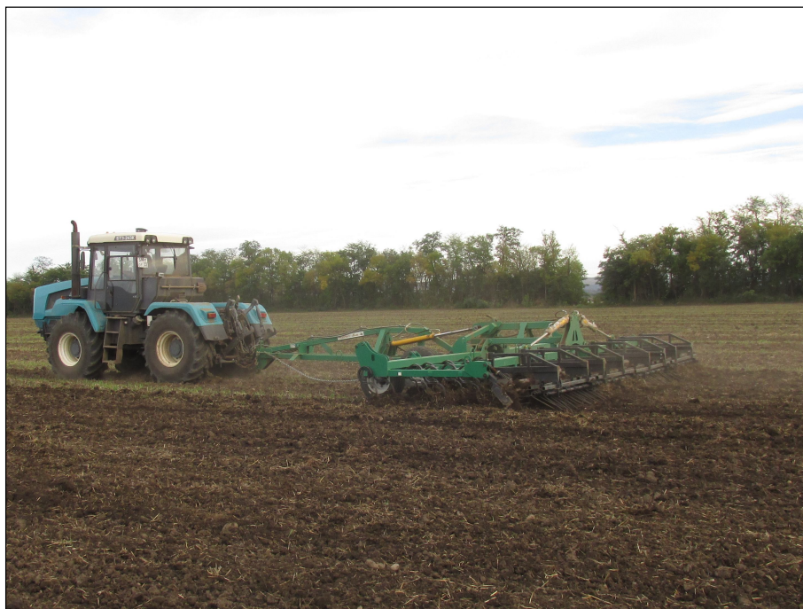
Рисунок 4 – Трактор сельскохозяйственный колесный общего назначения категории Т1, тип БТЗ-240К, вариант 3, версии 20: БТЗ-243К.20, в агрегате с культиватором КПУ-8ПЕ, на предпосевной культивации
