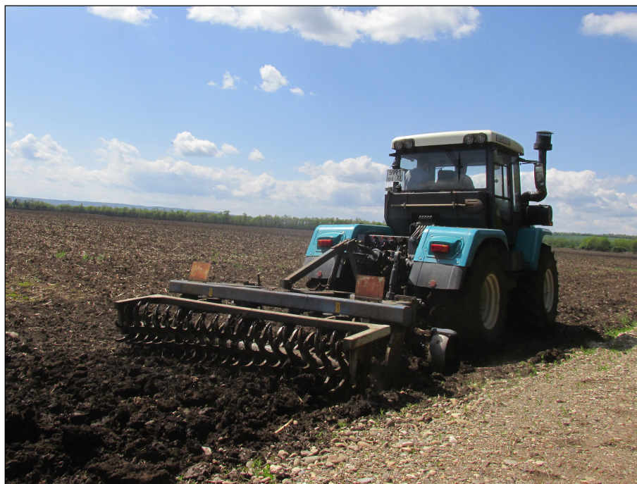
Рисунок 2 – Трактор сельскохозяйственный колесный общего назначения категории Т1, тип БТЗ-240К, вариант 3, версии 20: БТЗ-243К.20, в агрегате с плугом чизельным ПЧН-3, на безотвальной обработке почвы (чизелевании)
