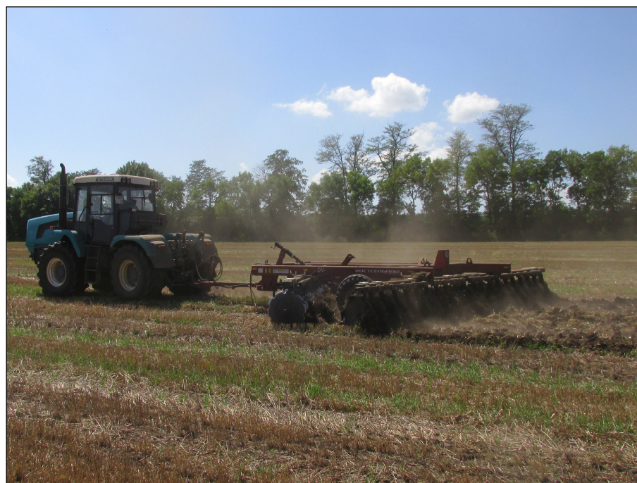
Рисунок 3 – Трактор сельскохозяйственный колесный общего назначения категории Т1, тип БТЗ-240К, вариант 3, версии 20: БТЗ-243К.20, в агрегате с бороной дисковой DV 1000/600, на дисковом лущении стерни озимой пшеницы (1 след)
