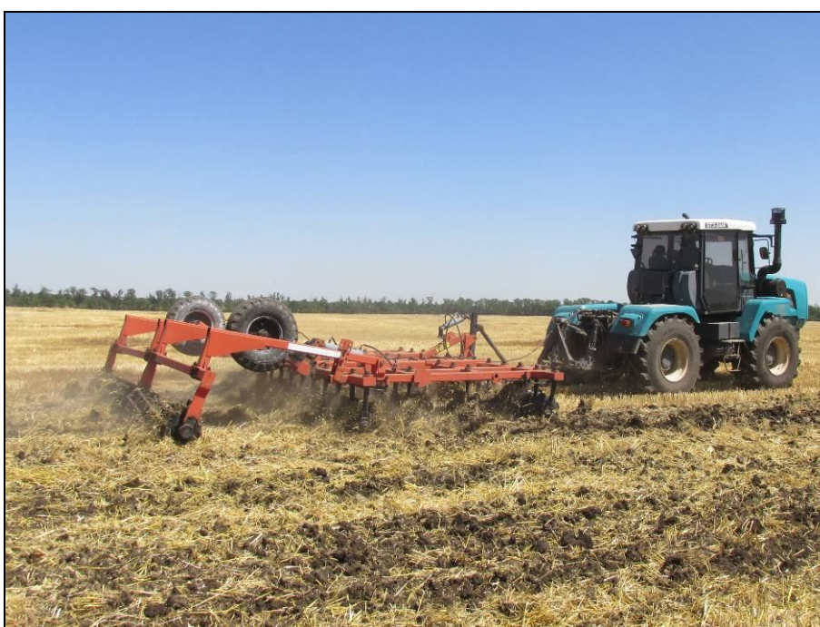
Рисунок 3 – Трактор сельскохозяйственный колесный общего назначения категории Т1, тип БТЗ-240К, вариант 4, версии 20: БТЗ-244К.20, в агрегате с бороной дисковой БДМ-5×4, на дисковом лушении стерни озимого ячменя (1 след)
