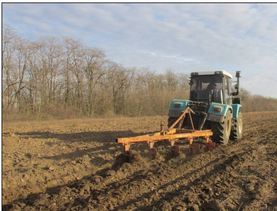
Рисунок 4 – Трактор сельскохозяйственный колесный общего назначения категории Т1, тип БТЗ-240К, вариант 4, версии 20: БТЗ-244К.20, в агрегате с плугом ПН-5-35, на отвальной обработке почвы
