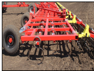
Рабочие органы – стрельчатые лапы на S-образных пружинных стойках
