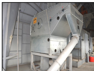
Оборудование для обработки и очистки зерна Alfa 100 в работе в составе технологической линии
