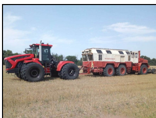
Трактор "Кировец" К-730М Стандарт 1 со сдвоенными колесами в агрегате с тяговой лабораторией ТЛК "Кировец" при проведении энергетической оценки
