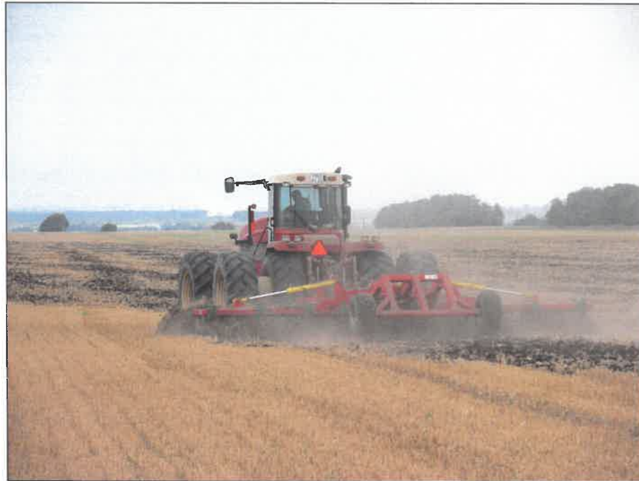
Рисунок 2 – Борона дисковая модернизированная марки "Диас", модель БДМ-8×3ПК-ШКС в агрегате с трактором Versatile 2375 на дисковом лущении стерни озимой пшеницы (1 след)
