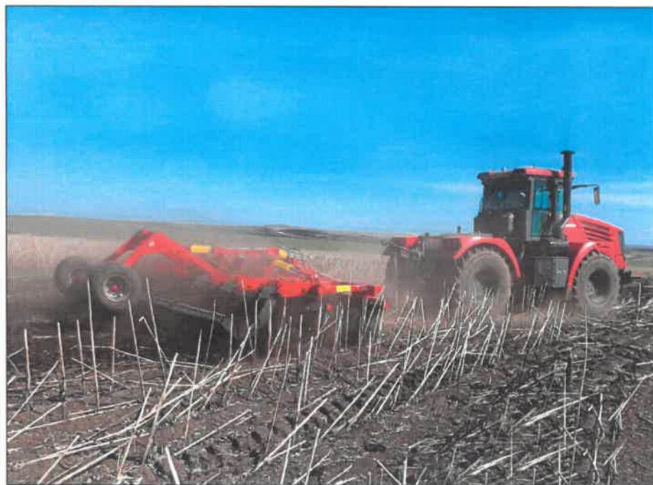
Рисунок 3 – Борона дисковая модернизированная марки "Диас", модель БДМ-8×3ПК-ШКС в агрегате с трактором Кировец К-744РЗ на дисковом лущении пожнивных остатков подсолнечника (1 след)
