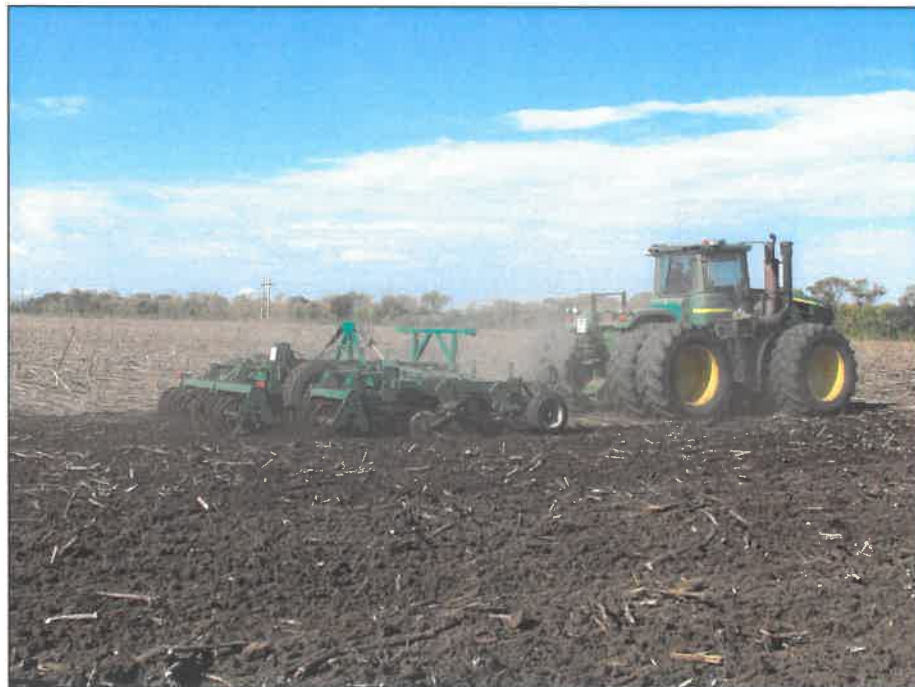
Рисунок 3 – Борона дисковая тяжелая БДУ-6,4 в агрегате с трактором John Deere 9430 на дисковом лущении пожнивных остатков подсолнечника (1 след)
