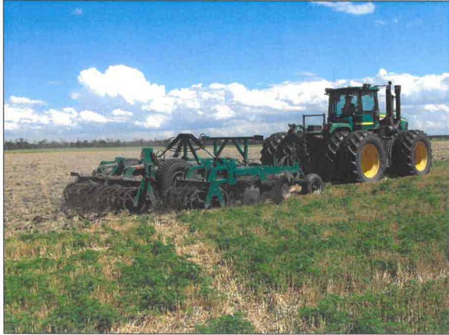
Рисунок 2 – Борона дисковая тяжелая БДУ-6,4 в агрегате с трактором John Deere 9430 на дисковом лущении стерни озимой пшеницы (1 след)
