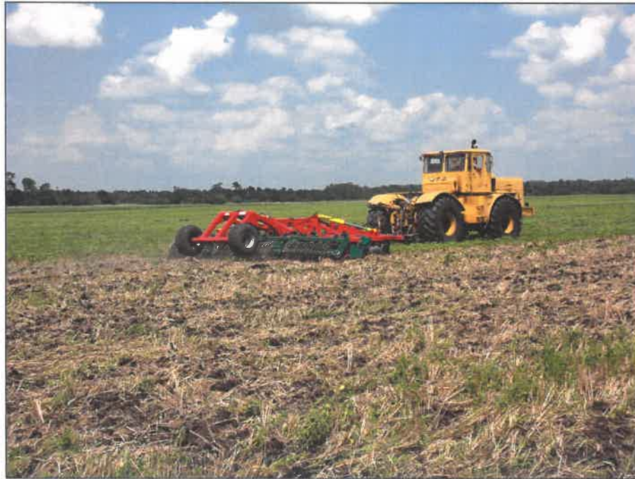
Рисунок 2 – Борона дисковая модернизированная марки "Диас", модель БДМ-6×3ПК-ШКС в агрегате с трактором К-700 на дисковом лущении стерни озимой пшеницы (1 след)
