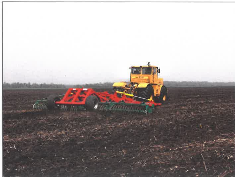
Рисунок 3 – Борона дисковая модернизированная марки "Диас", модель БДМ-6×3-ПК-ШКС в агрегате с трактором К-700 на дисковом лущении пожнивных остатков подсолнечника (2 след)
