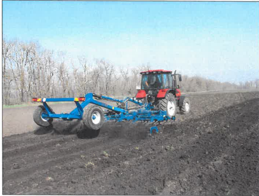
Рисунок 2 – Культиватор предпосевной торговой марки "TIGARBO", модель КПИ-6, в агрегате с трактором Беларус-1523 на сплошной культивации
