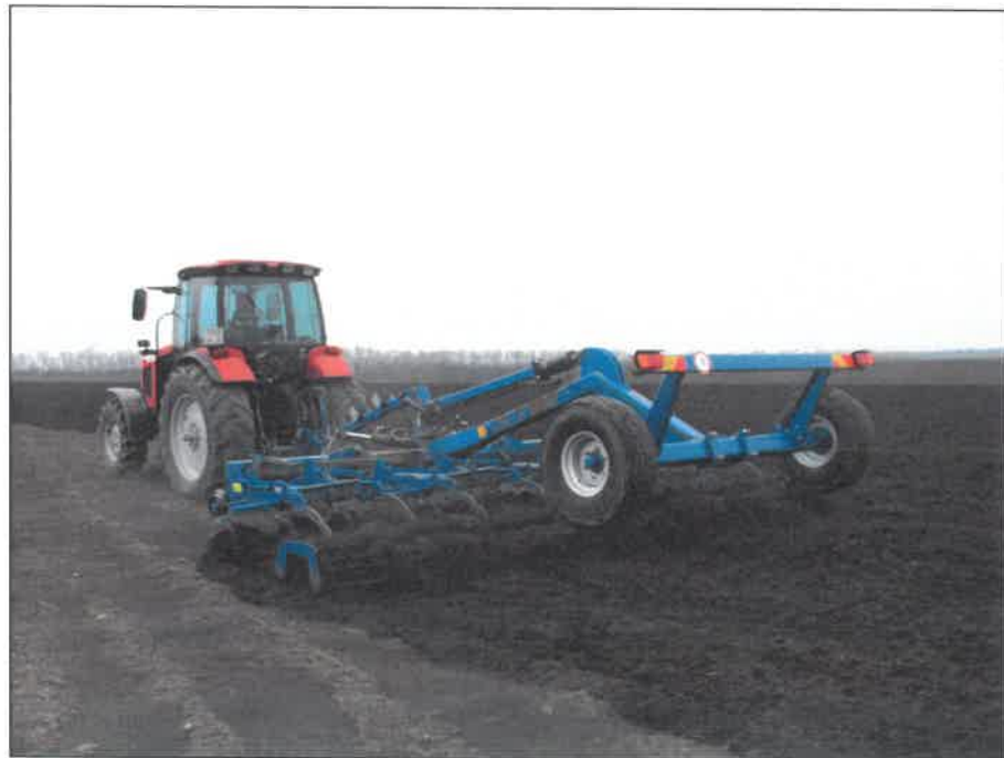
Рисунок 3 – Культиватор предпосевной торговой марки "TIGARBO", модель КПИ-6, в агрегате с трактором Беларус-2022 на предпосевной культивации
