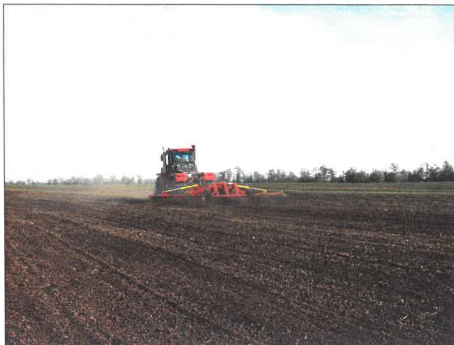
Рисунок 2 – Борона дисковая модернизированная марки "Диас", модель БДМ-9×2ПК-Д-ШКС в агрегате с трактором К 744РЗ на дисковом лушении стерни озимой пшеницы (2 след)
