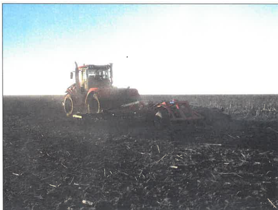
Рисунок 3 – Борона дисковая модернизированная марки "Диас", модель БДМ-9×2ПК-Д-ШКС в агрегате с трактором К-742МСт1 на дисковом лушении пожнивных остатков подсолнечника (1 след)
