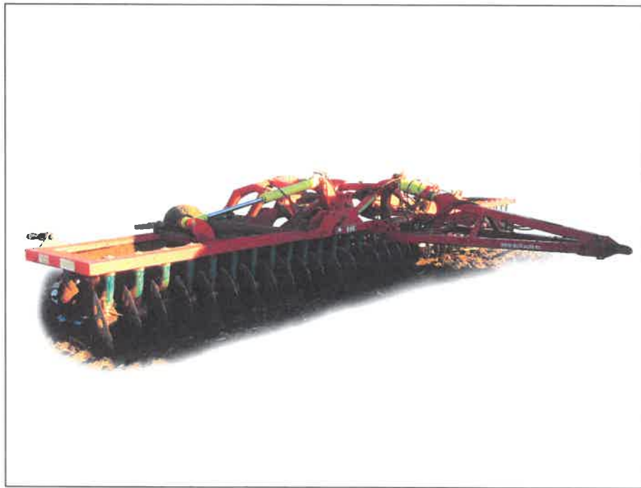
Рисунок 1 – Борона дисковая модернизированная марки "Диас", модель БДМ-9×2ПК-Д-ШКС, вид спереди справа
