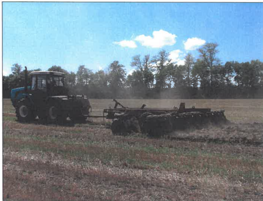
Рисунок 3 – Трактор сельскохозяйственный колесный общего назначения категории Т1, тип БТЗ-240К, вариант 3, версии 20: БТЗ-243К.20, в агрегате с бороной дисковой DV 1000/600, на дисковом лущении стерни озимой пшеницы (1 след)
