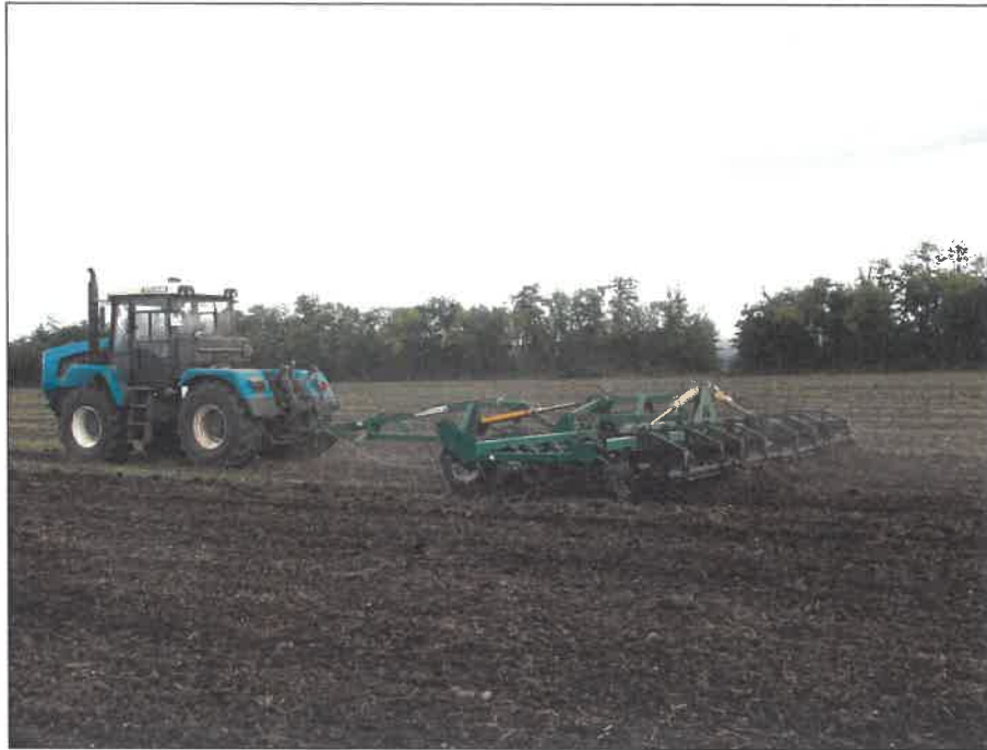
Рисунок 4 – Трактор сельскохозяйственный колесный общего назначения категории Т1, тип БТЗ-240К, вариант 3, версии 20: БТЗ-243К.20, в агрегате с культиватором КПУ-8ПЕ, на предпосевной культивации
