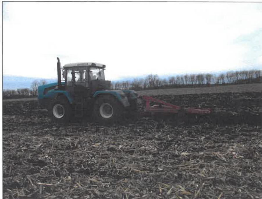
Рисунок 5 – Трактор сельскохозяйственный колесный общего назначения категории Т1, тип БТЗ-240К, вариант 3, версии 20: БТЗ-243К.20, в агрегате с плугом ПС 5/50, на отвальной обработке почвы
