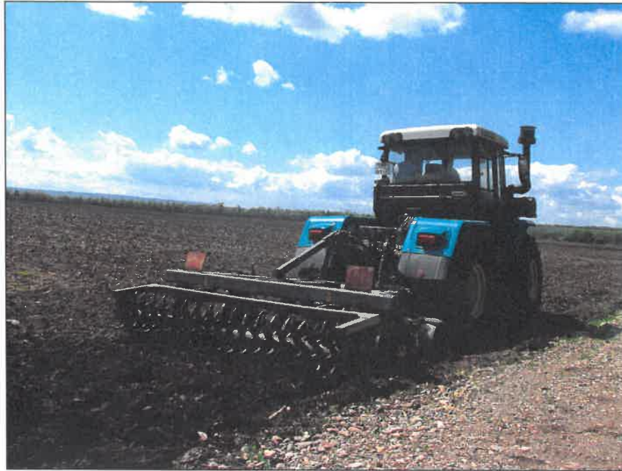
Рисунок 2 – Трактор сельскохозяйственный колесный общего назначения категории Т1, тип БТЗ-240К, вариант 3, версии 20: БТЗ-243К.20, в агрегате с плугом чизельным ПЧН-3, на безотвальной обработке почвы (чизелевании)
