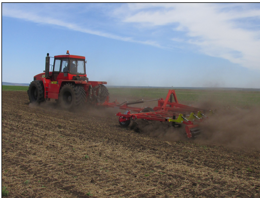
Рисунок 2 – Средний предпосевной культиватор "Tillermaster-6200" в агрегате с трактором Т-360 Agromaster на сплошной культивации почвы
