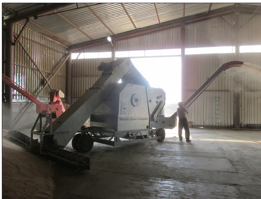
Рисунок 2 – Передвижное зерноочистительное устройство ALFA MGC 150, на предварительной очистке зернового вороха пшеницы
