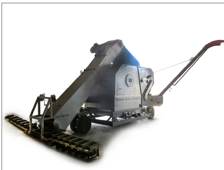
Рисунок 1 – Передвижное зерноочистительное устройство ALFA MGC 150, вид спереди слева
