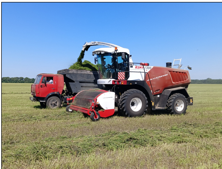
Рисунок 2 – Комбайн кормоуборочный самоходный РСМ-120 "RSM F 1300", на подборе валков подвяленной люцерны
