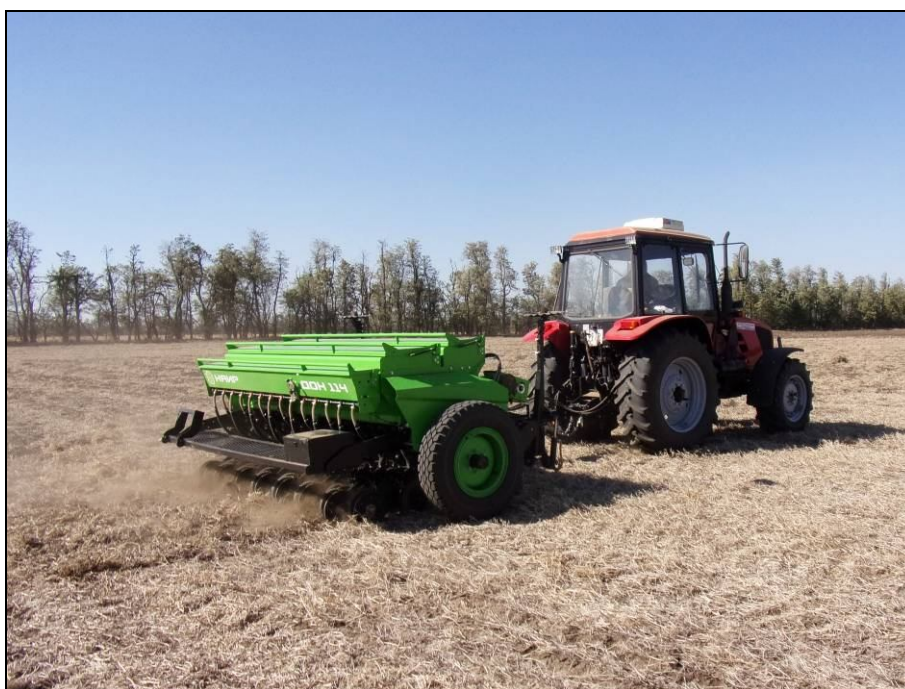
Рисунок 3 – Сеялка Дон 114, в агрегате с трактором Беларус 1025.3, на посеве озимой пшеницы
