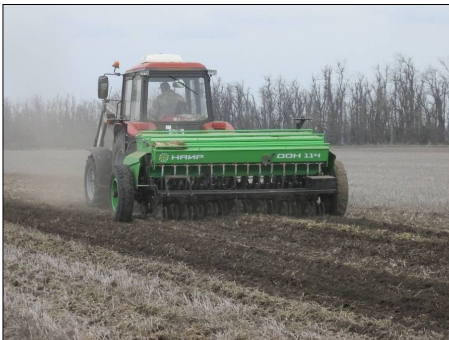
Рисунок 2 – Сеялка Дон 114, в агрегате с трактором Беларус 1025.3, на посеве гороха
