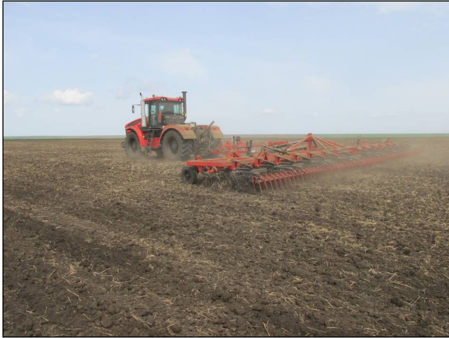
Рисунок 2 – Культиватор сплошной, серии КС(У), модели КС-14(УС)-03.00 EURO в агрегате с трактором К-742 МСт1 "Кировец", на предпосевной культивации почвы
