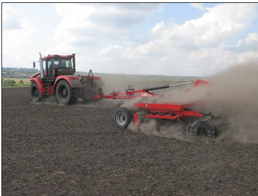
Рисунок 2 – Культиватор сплошной, серии КС(П), модели КС-10(П)-03.00 EURO в агрегате с трактором К-735 МСт "Кировец", на сплошной культивации почвы
