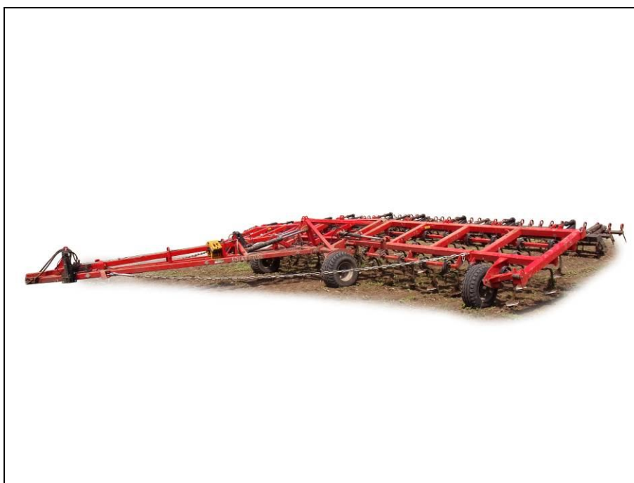
Рисунок 1 – Культиватор сплошной, серии КС(У), модели КС-12(У)-03.00 EURO, вид спереди слева
