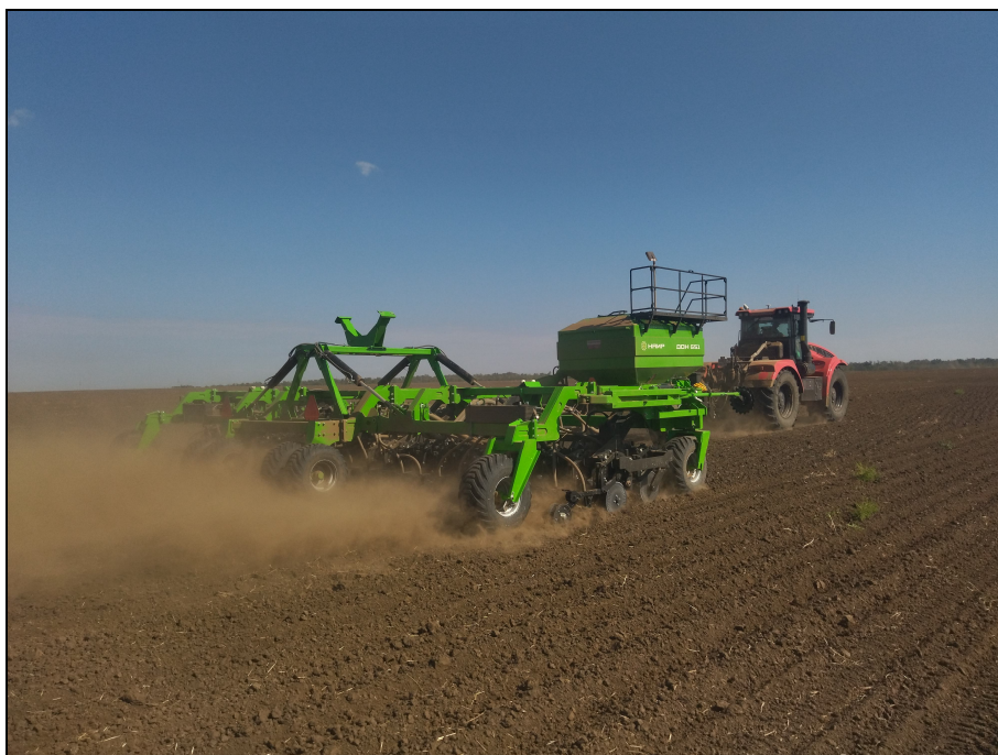
Рисунок 2 – Посевной комплекс "Дон-651" (анкерный), в агрегате с трактором К-742 МСт1 "Кировец", на посеве озимой пшеницы
