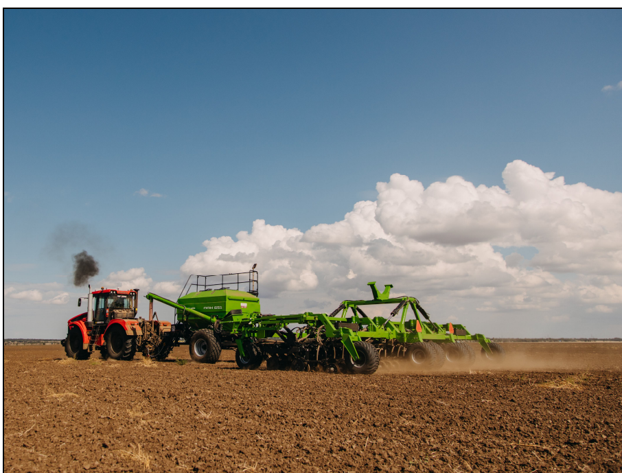
Рисунок 3 – Посевной комплекс "Дон-651" (анкерный), в агрегате с трактором К-742 МСт1 "Кировец", на посеве семян гороха
