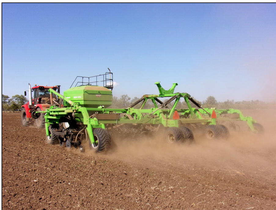
Рисунок 4 – Посевной комплекс "Дон-651" (анкерный), в агрегате с трактором К-742 МСт1 "Кировец", на посеве семян люцерны
